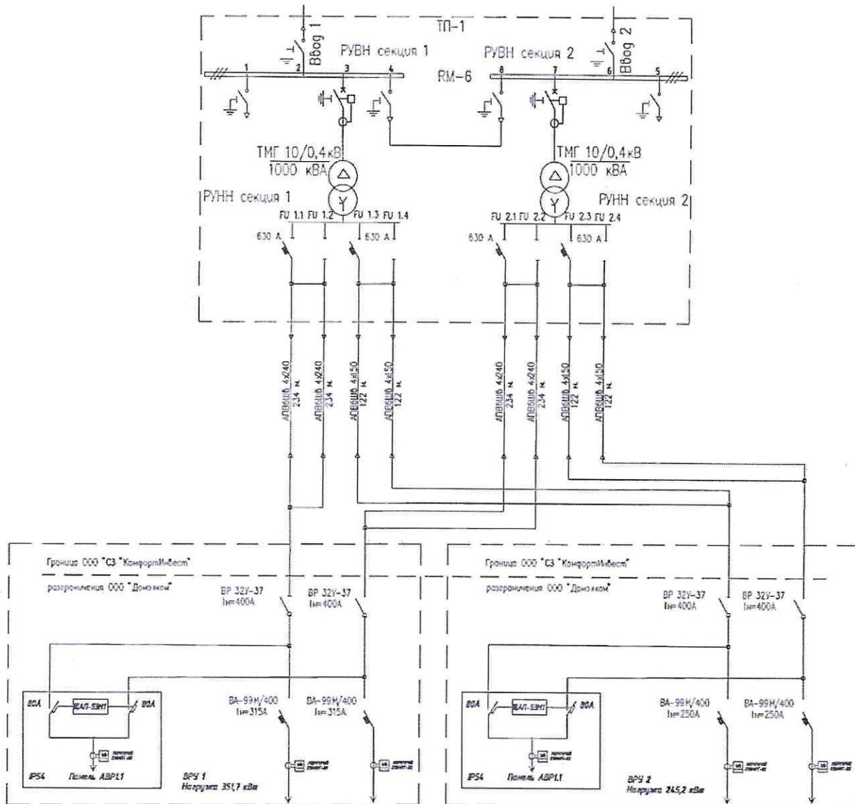
**Примечание:** в схеме указываются места установки и номера приборов учета, параметры измерительных трансформаторов тока и напряжения, границы балансовой принадлежности (красный цвет) и эксплуатационной ответственности (синий цвет), границы с субабонентами/транзитными потребителями (зеленый цвет), длину и марку питающих кабелей (проводов).
